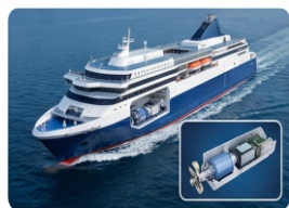
船舶中压直流电力推进系统
