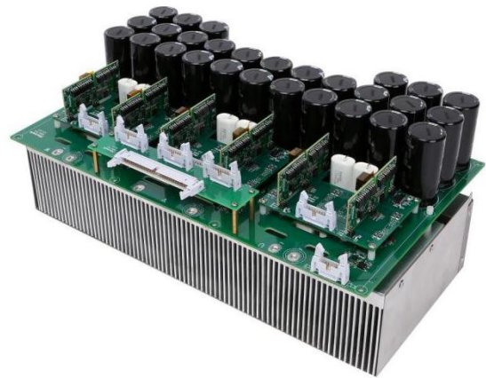
图 9 基于 D-CORE 驱动核的 100kW/380VAC 模组
